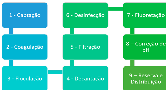
Esquema das Etapas do Tratamento de Água (Sabesp) Elaborado para o material
