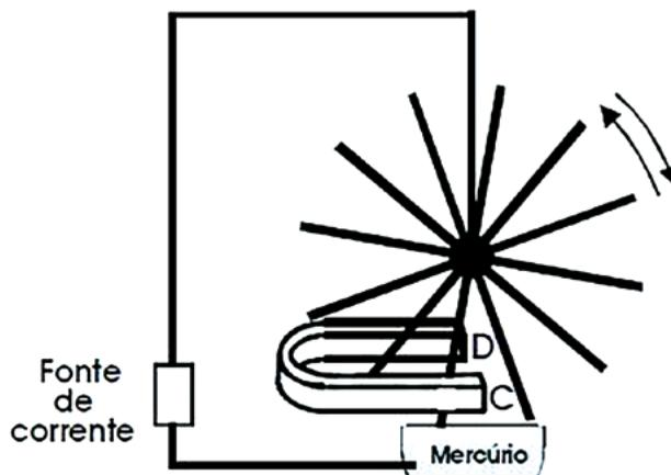
O circuito elétrico fecha-se no encontro da ponta de um raio da roda com o mercúrio. Devido ao campo magnético produzido pelo ímã, de polos C e D, a roda gira, mantendo sempre um raio em contato com o mercúrio. Assim, vê-se a roda girando no sentido
