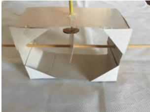
12. Por esse canudo, passe um palito de churrasco, de forma que o palito fique estabilizado. Fixe com a cola quente, o seguidor do came na ponta do palito. Importante: caso o seguidor do came fique muito leve, ele pode não gerar atrito suficiente para se mover adequadamente. Uma solução é adicionar algum peso nele. Cole um pedaço de borracha escolar ou pequenas arruelas ou porcas para aumentar seu peso.
