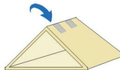
Recorte um retângulo de papelão. Na parte inferior da barra, recorte e cole duas tiras de papelão para fazer um limitador. Esse limitador serve para que a barra rígida não deslize da base de apoio.
