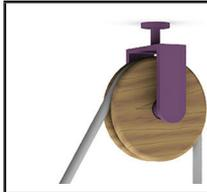
As roldanas são utilizadas para elevar objetos utilizando cordas ou cabos. Elas são constituídas por uma roda com um sulco, no qual corre uma corda que pode ser fixa ou móvel.
