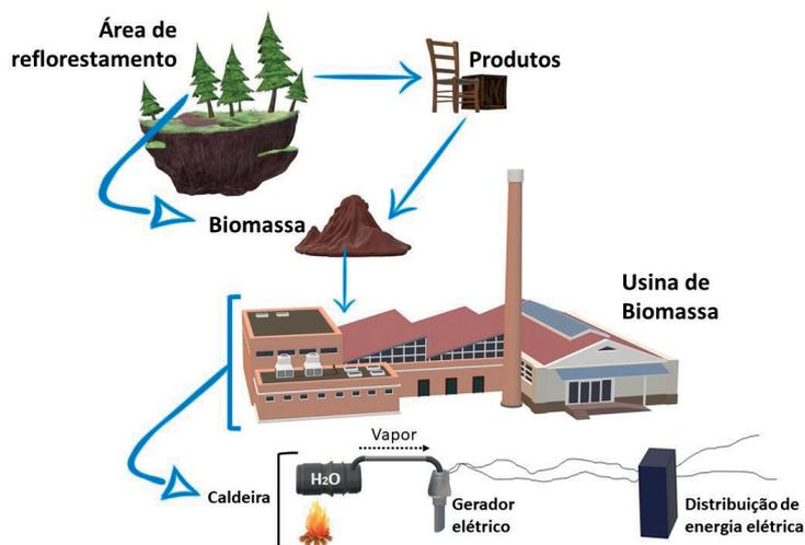
**Imagem 8** – Produção de energia elétrica a partir da biomassa (matéria orgânica). Fonte: Elaborado pelos autores.
