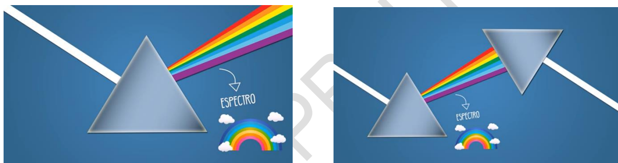
Fonte: O prisma demonstra a divisão da luz nas sete cores do espectro. Fig. 4 O prisma invertido recompõe a Luz
