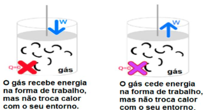
Imagem 7: Transformação Adiabática – Fonte: Elaborado para o Material
