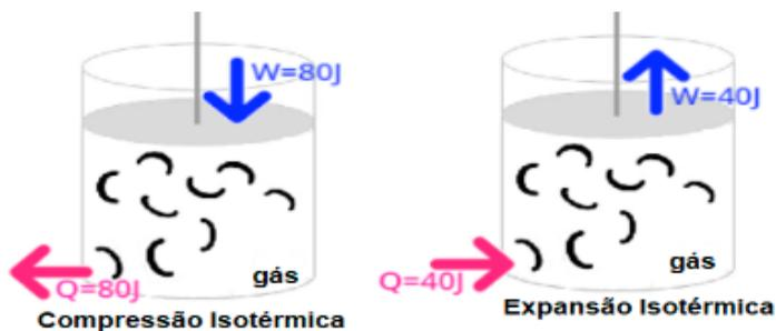
Imagem 5: Transformação Isotérmica – Fonte: Elaborado para o Material
