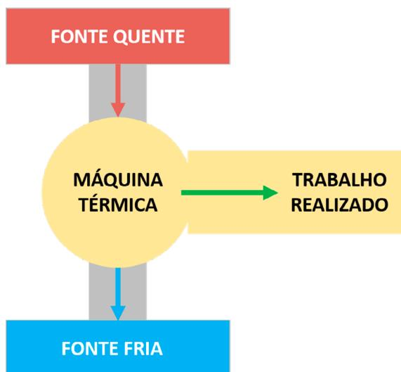
Imagem : Representação de uma máquina Térmica – Fonte: Elaborado para o Material
