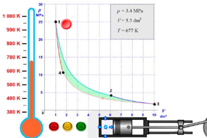
Imagem 2: Simulador do ciclo de Carnot – Fonte: Adaptado do [www.vascack.com.cz](http://www.vascack.com.cz)
