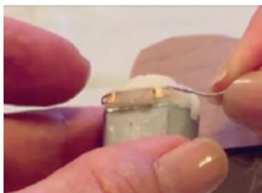
13. Fixe a hélice no eixo do motor com cola quente. Cuidado para não colar na base do motor, pois a hélice precisa girar. Faça um teste manual.
