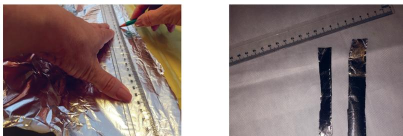
**8º PASSO:** PEGUE UMA TIRA E COLE EM CIMA DE UMA DAS LINHAS DO CIRCUITO. PASSE POUCA COLA PARA NÃO RASGAR O PAPEL ALUMÍNIO. COLE DE UM LADO O PAPEL ALUMÍNIO DE FORMA QUE SUA EXTREMIDADE FIQUE DENTRO DO LOCAL MARCADO DA BATERIA. DO OUTRO LADO COLE A TIRA DE MANEIRA QUE A EXTREMIDADE FIQUE NA PARTE DOBRADA DO CARTÃO. DEPOIS FIXE COM FITA ADESIVA A BATERIA NO LOCAL QUE VOCÊ FEZ O DESENHO.
