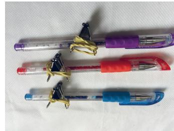
FIXE AS CANETAS NO CD, SEPARANDO-AS UNIFORMEMENTE. EM SEGUIDA FIXE O CLIPE COM COLA QUENTE PARA QUE A CANETA NÃO SOLTE QUANDO O ROBÔ ESTIVER EM FUNCIONAMENTO.
