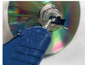
INSIRA O EIXO DO MOTOR NO CENTRO DO CD E COLE-O COM COLA QUENTE. PASSE COLA O SUFICIENTE PARA QUE O MOTOR FIQUE BEM FIRME E NÃO SE SOLTE QUANDO ESTIVER FUNCIONANDO.
