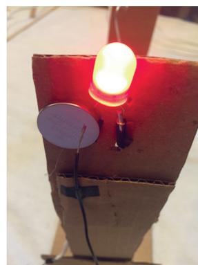
11. O fio do polo positivo deve ficar próximo à bateria. Recorte um pedaço de papelão cole na lateral de forma que ao pressionar, encosta o fio na bateria.
