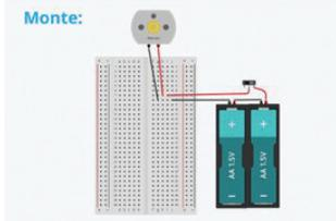
**Dica:** Ao inverter os fios do motor, você muda o seu sentido de rotação. Prenda um pedaço de fita na haste do motor para visualizar melhor isso acontecendo.
