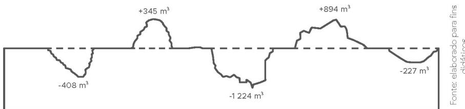
No trecho mostrado aparecem depressões e oscilações de terra. Sendo assim, uma máquina irá tampar as depressões e cortar as oscilações dessa terra.
