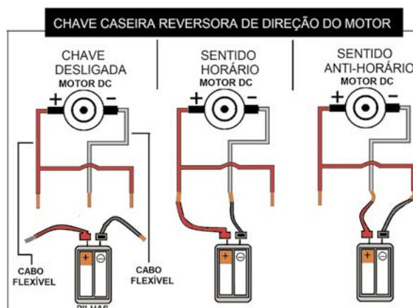
Imagem: Chave reversora de direção do motor
