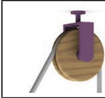
As roldanas são utilizadas para elevar objetos utilizando cordas ou cabos. Elas são constituídas por uma roda com um sulco, no qual corre uma corda que pode ser fixa ou móvel.
