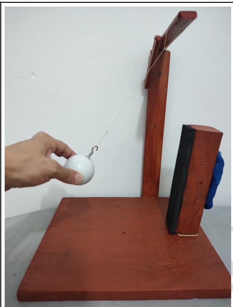
Imagem 4: Colisão com a placa de borracha. Elaborado por Marcelo Vio para o material.
