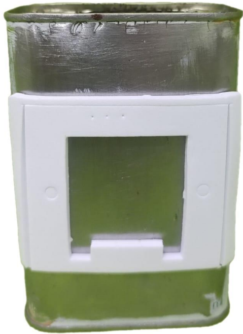
Imagem 6: Junta de isolamento recortada e aderida ao recipiente. Elaborado para o material.
