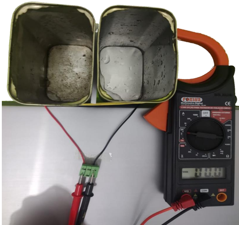
Imagem 9: Aferindo a DDP da pastilha Peltier, parte I. Elaborado para o material.
