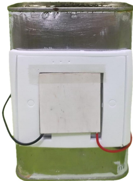
Imagem 7: Pastilha Peltier em contato com o recipiente. Elaborado para o material.
