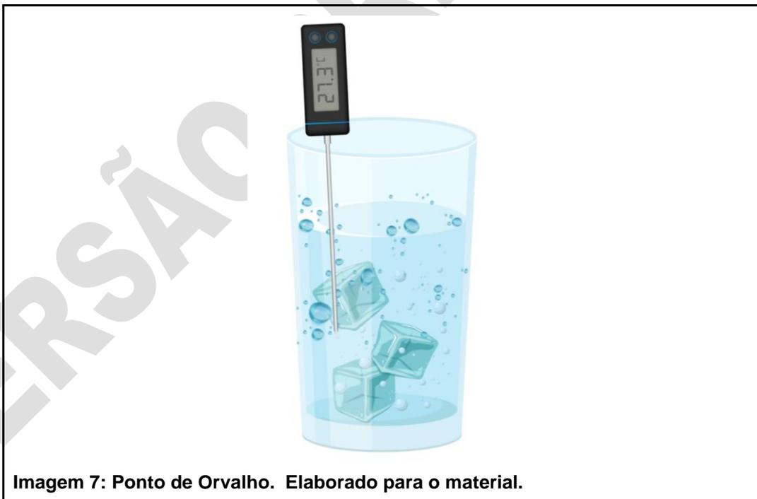
Para compreender a umidade relativa do ar, é importante identificar a quantidade de água presente no ar. Nesse sentido, quando se observa a água na superfície da vasilha, é possível estimar a temperatura necessária para saturar a água presente no ar.
