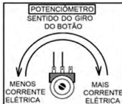
Imagem: Giro do botão- Potenciômetro_SPFE_2020
