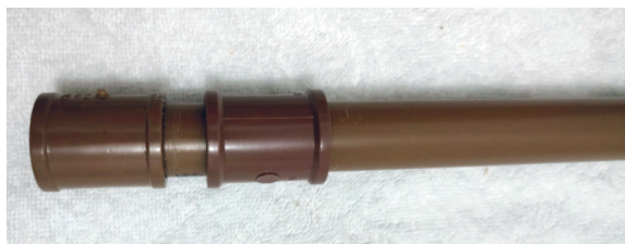
Imagem 17: Etapa 14 da montagem da bomba d'água. Elaborado para o material.
