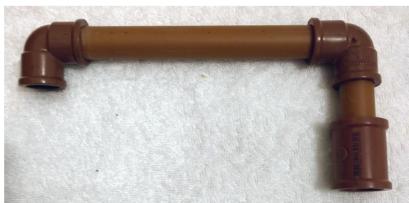
Imagem 7: Etapa 4 da montagem da bomba d'água. Elaborado para o material.
