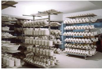
ELA É COMPOSTA PRINCIPALMENTE DE FELDSPATO, QUARTZO E ARGILA. A CERÂMICA É MOLDADA, PASSA POR UM PROCESSO DE SECAGEM E DEPOIS VAI PARA UM FORNO EXTREMAMENTE QUENTE. E, DEPENDENDO DA FINALIDADE, PODE PASSAR POR UM PROCESSO DE ACABAMENTO.
