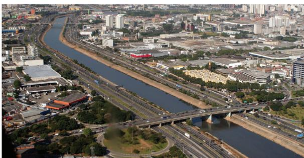
**Canalização dos rios:** é um processo em que as pessoas modificam o curso natural de um rio, criando canais artificiais para que a água flua de forma controlada. Isso é feito por meio da construção de paredes, ao longo das margens dos rios, levando a água em uma única direção.
