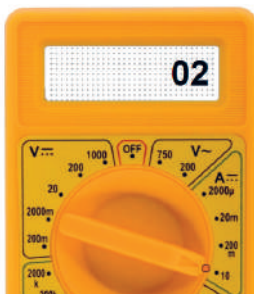
Imagem 3: Multímetro utilizado para medir corrente elétrica – Elaborado para o material.
