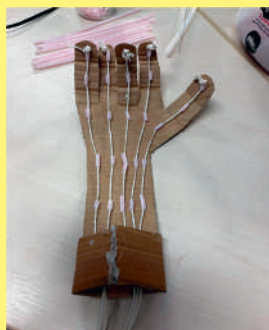
Mão mecânica criada com canudos, barbante e papelão.
